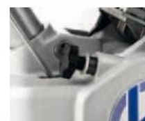
Lehce nastavitelný tlak válce
