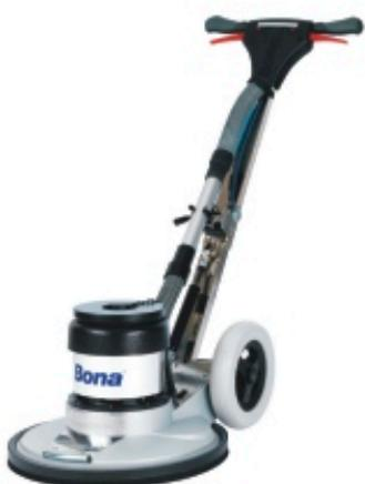
Při posledním broušení lze v zásadě postupovat jako u broušení jemného. Podle zrnitosti broušení před tmelením spár a podle spotřebovaného množství tmelu se provede volba následující zrnitosti. Při nadměrném nánosu tmelu se doporučuje broušení se stejnou zrnitostí jako před tmelením spár. U různých tmelů je třeba sledovat rychlé opotřebení brusiva, což může vést speciálně u broušení okrajů a rohů k brusným / spáleným stopám. Zejména nevytvrzený tmel způsobuje rychlé zlepení brusného kotouče.
