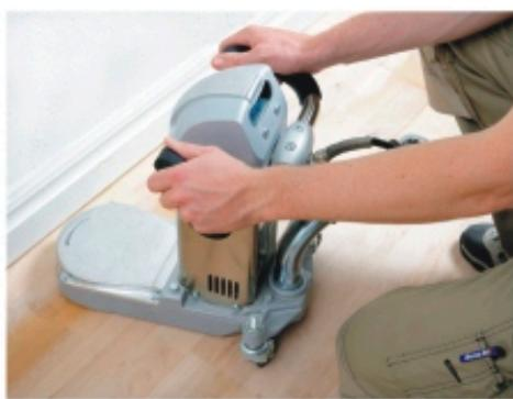
Aby se zamezilo nekvalitnímu výbrusu (probrusům), musí být stroj během broušení stále v pohybu. Pro potlačení viditelného přechodu mezi plošným a okrajovým broušením je třeba použít stejně zrnitosti brusiva.
